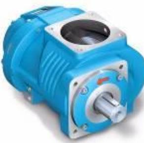
**Винтовой блок EVO9** производится компанией Rotorcomp (Германия) и является основой винтового компрессора. Визуально он представляет собой чугунный корпус, внутри которого, на подшипниках размещены два ротора, сжимающие воздух.
